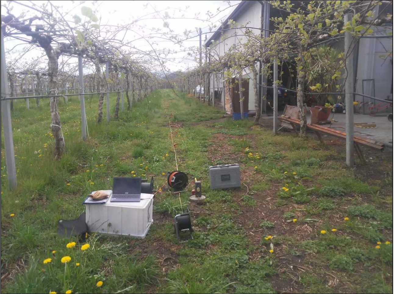
Figura 15: immagine fotografica della posizione e della strumentazione utilizzata per la misura con tecnica MASW nell'area di interesse.
