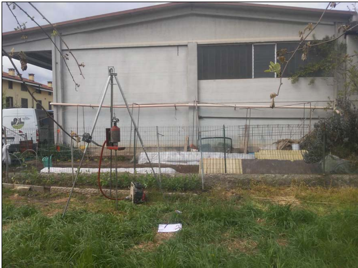
Figura 6: immagine fotografica della strumentazione utilizzata per la realizzazione della prova penetrometrica PP2-BAR-FAR nell'area di intervento.
