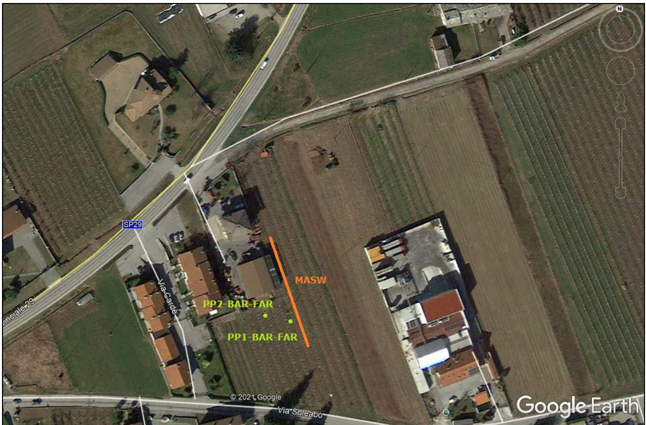
Figura 4: ubicazione delle indagini penetrometriche e geofisiche eseguite nell'area di intervento su immagine satellitare tratta dal software Google Earth.
